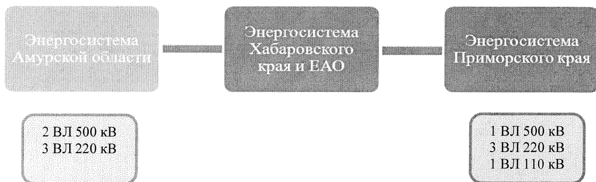
Рисунок 10 – Блок-схема внешних электрических связей ЭС Хабаровского края и ЕАО
